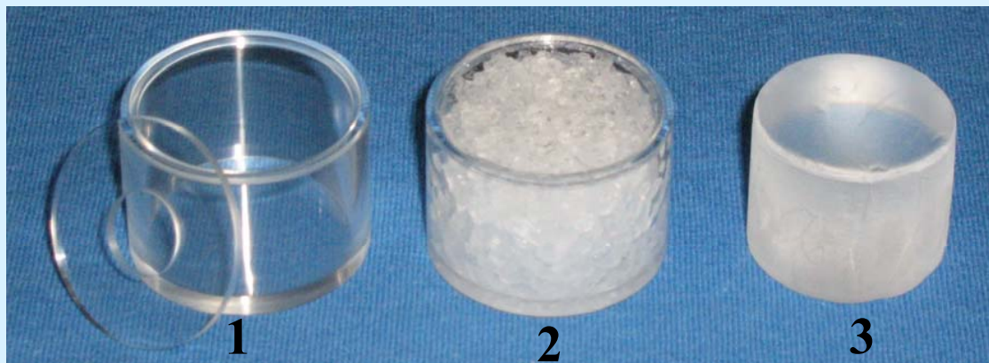
Рис.1 Фотография контейнера для композиционного детектора (1), образца композиционного детектора Ø30 мм×20 мм (2) и эталонного монокристалла стильбена Ø25×20 мм (3).
